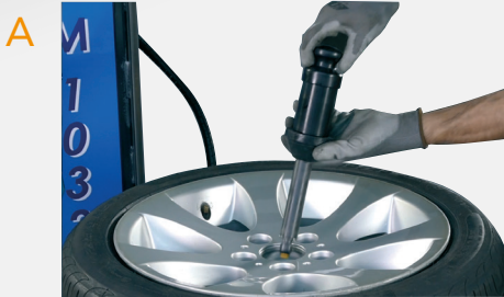
A EINSETZEN DES GRIFFS MIT SPANNKEGEL
