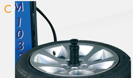
C FESTSPANNEN DES RADS DURCH LOSLASSEN DES PEDALS
