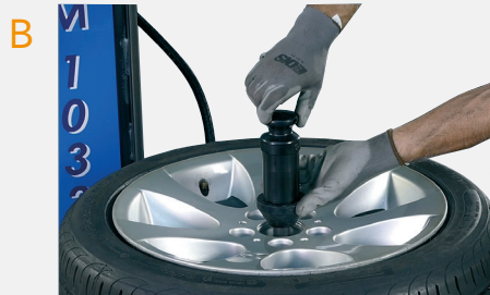
B POSITIONIEREN DES GRIFFS AM DER FELGE
